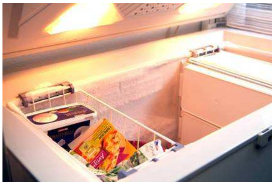
Kühltruhe, bereits leicht vereist
